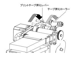
1 左イラストのプリントテープ押えレバーを後ろに 押すとテープ押えローラーが奥側に倒れます。
