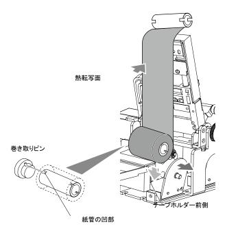
4 新しいプリントテープを左イラストのようにテープの熱転写面(インクが塗ってある面)が手前にくるようにして紙管の切り抜き凹部分を送りピン凸部分(出っ張り)に合うようにセットし、はめこみながらテープホルダー(前側)で紙管を挟んで固定してください。
