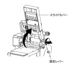
2 左イラストの固定レバーを右 (矢印側) にスライドさせ、その状態でスライドカバーを手で上に持ち上げます。
