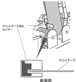
5 プリントテープが逆さコの字形の「プリントテープ切れセンサー」の中央を通るようにセットしてください。(左イラストを参照)のように通してください。
