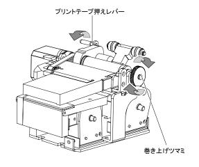
9 巻き上げツマミを回してテープの弛みを取って から、プリントテープ押さえレバーを手前に戻 してください。
