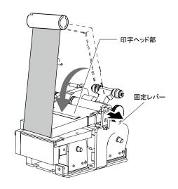
7 印字ヘッド部を左イラストのように手前に倒して元の位置に戻してください。
