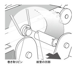
8 使用済みのプリントテープを巻き取るための紙管の切り抜き凹部分を、巻取りピン凸部分 (出っ張り)に合うようセットし、はめ込みながら、テープホルダー(後側)で紙管を挟んで固定してください。
