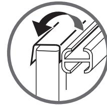
**注！** 貼り替え時の注意：センタードライテープの中心にヒーターが位置するようにして、センタードライテープの両サイドを圧着レバーに貼り付けてください。センタードライテープにシワがある状態で貼り付けると、シールにもシワ模様が出ます。
