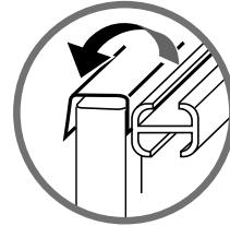
**注！** 貼り替え時の注意：センタードライテープの中心にヒーターが位置するようにして、センタードライテープの両サイドを圧着レバーに貼り付けてください。
