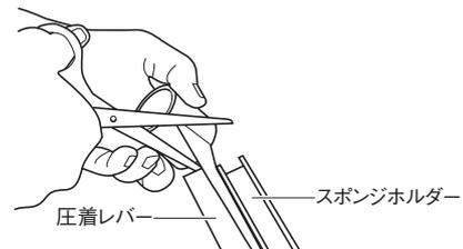
**注!** 貼り替え時の注意: センタードライテープの中心にヒーターが位置するようにして、センタードライテープの両サイドを圧着レバーに貼り付けてください。
