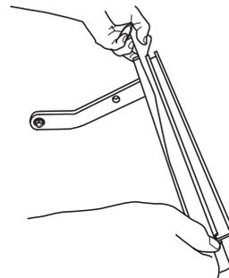
**注!** うまく貼り付けできない場合は、薄い定規などをスポンジホルダーと圧着レバーの間に差し込み、センタードライテープを圧着レバー側に押し付けながらスライドさせてください。
