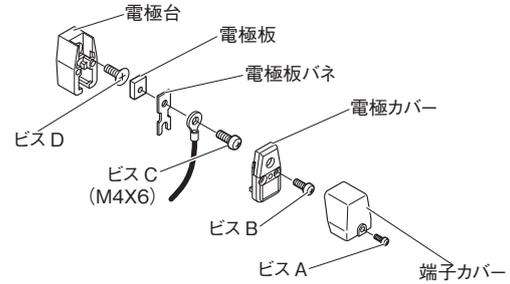
**警告** もし誤って、ビス C を紛失した場合、ビス C (M4 × 6) より長いビスを代用しないようにしてください。ビス C より長いビスを使用すると電極台を固定しているビス D と接触して、ショートする危険性があります。
