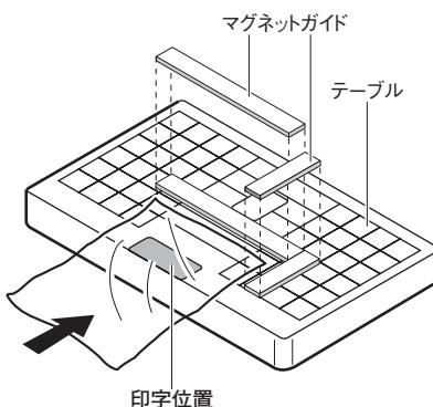
**注！** ハンドレバーを押し下げた際に、テープ送り調整軸、ヒーター部ユニット、活字固定ピンのつまみなどの部品にマグネットガイドが当たらないようにセットしてください。プリントテープの巻取り不良や、部品の破損などの原因となります。
