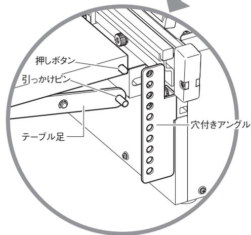
**⚠ 警告** 押しボタン、引っ掛けピンは必ず確実に穴付きアングルの穴へ差し込んでください。確実にセットされていないと、少しの衝撃やテーブルの持ち上げによってテーブルが外れたり傾いたり、落下してケガをする恐れがあります。
