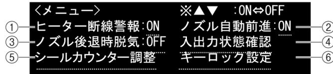
③ ノズル後退時脱気 (工場出荷時の設定 : ON)
