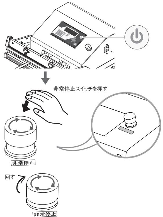
非常停止スイッチを押すと、ボタンスイッチにロックがかかります。ロックを解除する場合は、非常停止スイッチの上部を右方向に回転させると解除することができます。解除するとディスプレイ画面が再点灯します。
