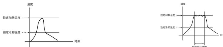
冷却 ⇒ シール時の冷却温度を 60 °C ~ 加熱温度設定値で設定可能です。
