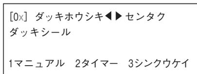
◀、▶ ボタンで「1 マニュアル」「2 タイマー」「3 シンクウケイ」から選択したい脱気方式にカーソルを合わせ、ENTER ボタンを押して確定すると加熱温度・時間、冷却温度設定画面に変わりますので必要に応じて各設定を行ってください。
