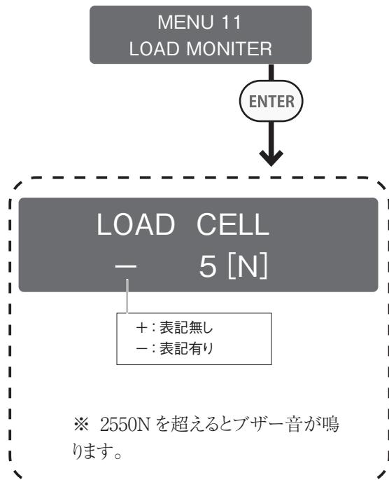
選択すると上の画面が表示され、現在圧力センサーに掛かっている荷重が表示されます。
