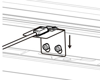
③本体左側面のDINコネクタに日常点検ユニットのコネクタを接続してください。
