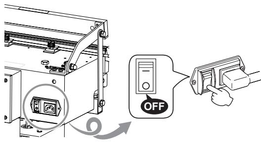
電源スイッチをOFFにしても各モードで設定した数値およびカウンターナンバー（シール回数）はコントロールユニットに記憶されています。もう一度電源スイッチをON状態にしても再度設定する必要はありません。
