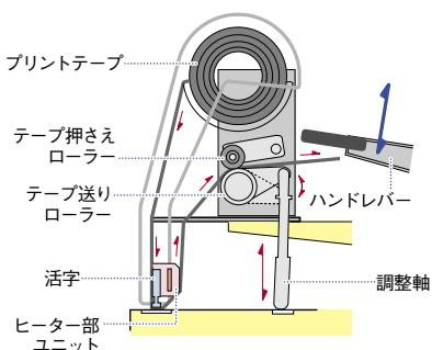
ハンドレバーを押し下げると調整軸が下がりテープ送りローラーを回転させプリントテープの未印字面を活字の位置へ移動させヒーター部ユニットでテープのカーボンを焼き付ける構造です。
