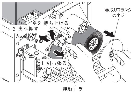
3 送り出しローラーに残ったプリントテープ巻取り紙管は取り外して、巻取りローラー側に取り付けてください。
