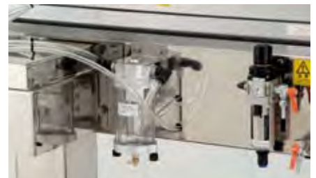
NTタイプ;背面より フィルターを装着しています
