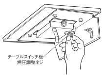
押圧調整ネジの中に調整スプリングが入っています
