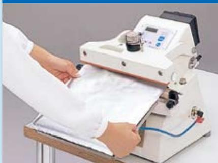
富士インパルス：電動シーラーは確実なシーリングに必要な「加熱時間」「冷却時間」を設定してシーリングを行うことができます。また、作業者の負荷が大きい手動操作、足踏み操作を行うことなくテーブルやエアペダル、フットスイッチを軽く押す操作で、シーリング作業を行えます。連続運転も可能です。
