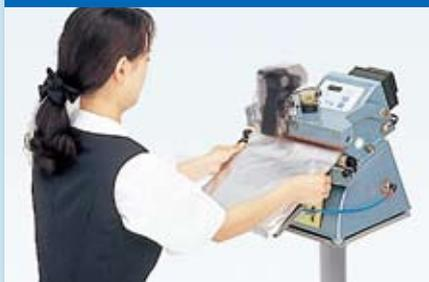
加熱温度コントロール機能：オンパル（ONPUL）搭載モデルは、高いシーリング精度が求められる現場に最適です。バリデーション対応のOPL-451-MDは、シーリング条件やシーリング作業毎の測定データを内部メモリに記録・保存し、USB接続により、測定データをパソコンへ転送し、データを維持管理することができます。
