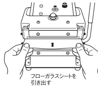
**MEMO** 圧着レバー上のビスを締め付ける時、フローガラスシート巻取棒押さえ(上)が回転しないように指で支えながらビスを締め付けてフローガラスシート巻取棒を固定してください。「9-3 上側フローガラスシートの交換」を参照してください。
