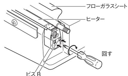
**注意** ビス B を緩めないと、ヒーターが左右に張られた状態のままになるのでヒーターを取り付ける際に適切に電極板と板バネの間にヒーター端子をセットできなくなります。
