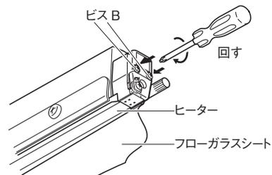
**注意** ビス B を緩めないと、ヒーターが左右に張られた状態のままになるのでヒーターを取り付ける際に適切に電極板と板バネの間にヒーター端子をセットできなくなります。
